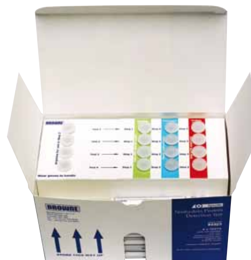
Kit di test alla Ninidrina per il rilevamento delle proteine
